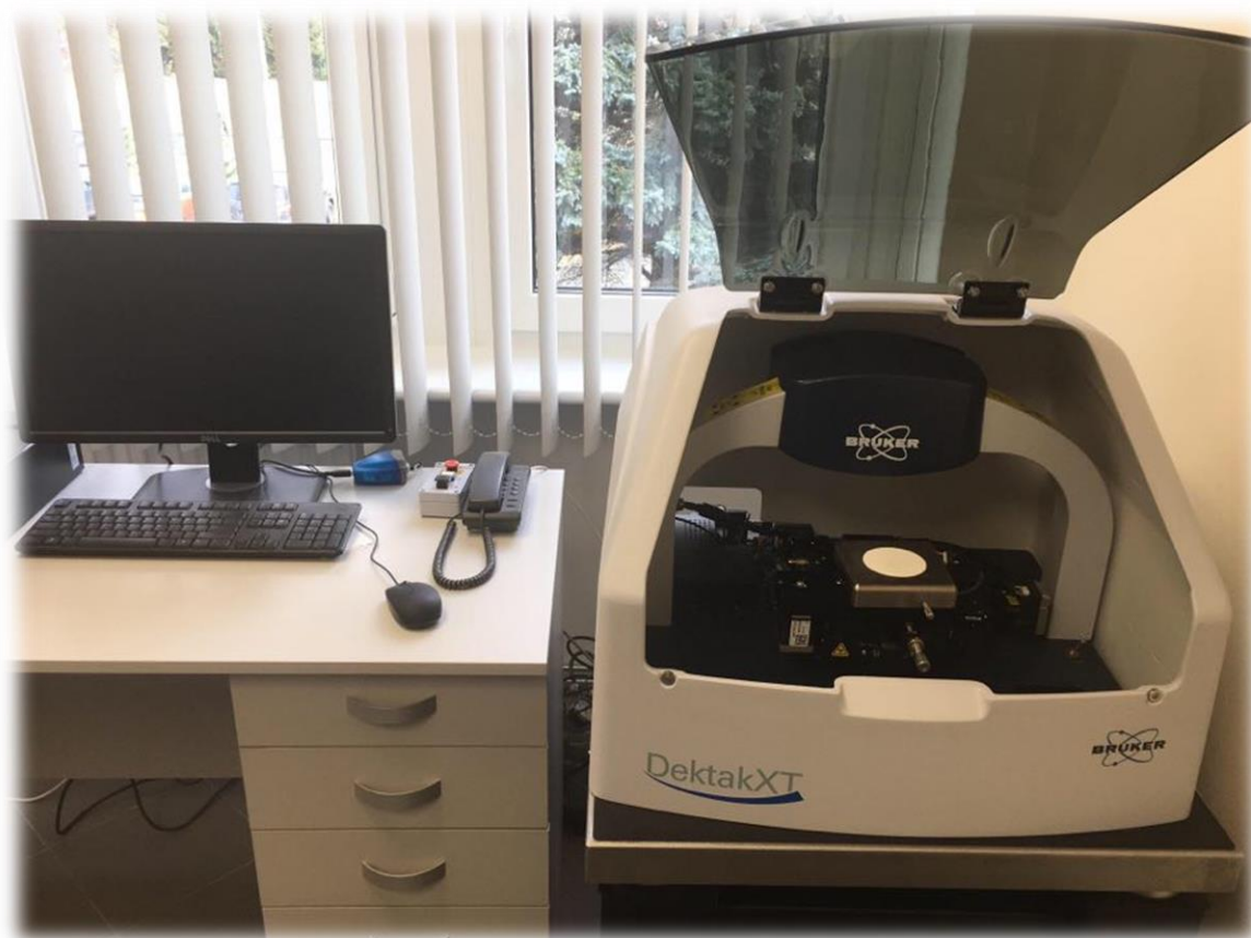
Rys. 3.1. Profilometr DektakXT firmy Bruker znajdujący się w IFM PAN.
