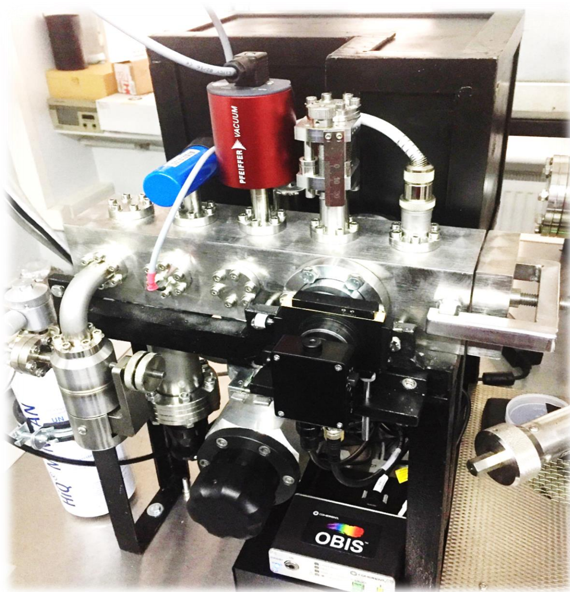
Rys. 4.2. Zdjęcie zbudowanej aparatury do pomiarów kinetyki absorpcji wodoru z fazy gazowej.
