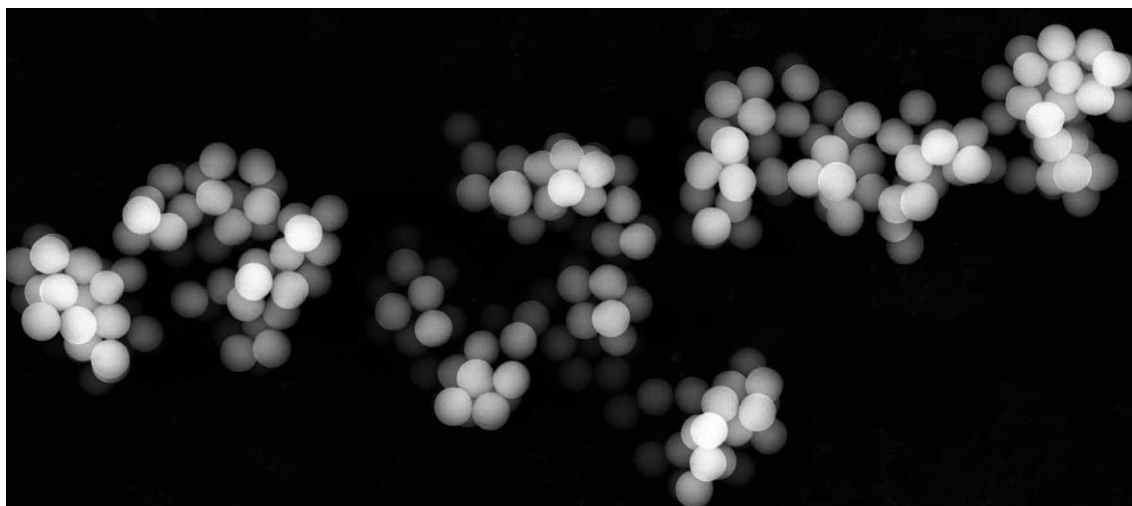
Rys 11 Zdjęcie SEM przedstawiające nanocząsteczki \text{SiO}_2 27 .
