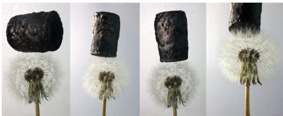
Rys. 3 Aerożel z częściowo zredukowanego tlenu grafenu na Mniszku pospolitym ( Taraxacum officinale ). Gęstość aerożelu – piany stałej, masa i objętość to odpowiednio 5 \text{ mg/cm}^3 , 30 mg, 6 \text{ cm}^3 .
